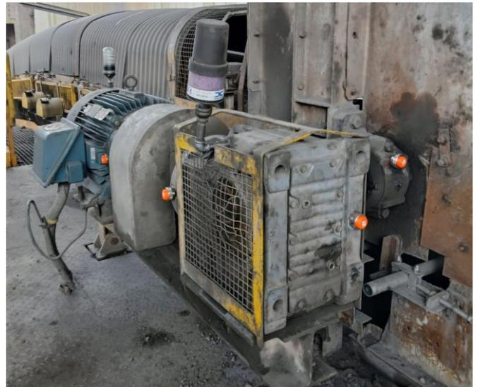
Figura 4: Montaje de sensores
